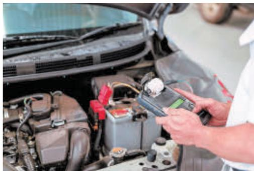
**1** Haga revisiones periódicas para saber el estado de la batería y el alternador de su carro, ya que si éste u otro componente presenta anomalías puede dañar la batería.
