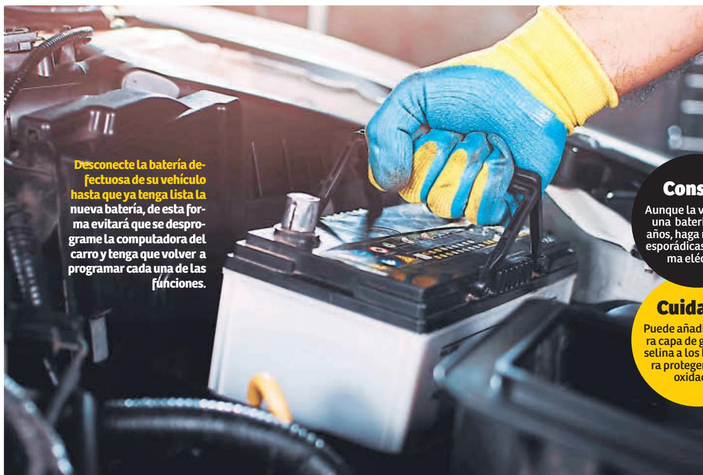
Desconecte la batería defectuosa de su vehículo hasta que ya tenga lista la nueva batería, de esta forma evitará que se des programe la computadora del carro y tenga que volver a programar cada una de las funciones.
