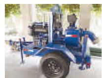
**BOMBA NUEVA** de agua 6"thompson equipz diesel 3cyl tipo: trash, equipado completo ubicación sap, 9991-3356
